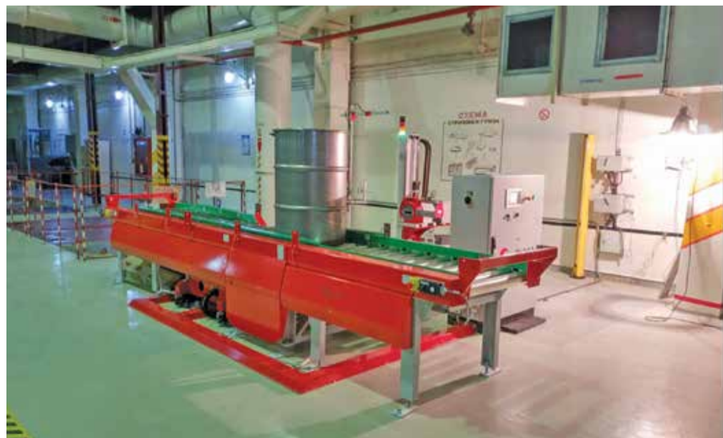
Установка вимірювання активності (паспортизації) РАВ.
