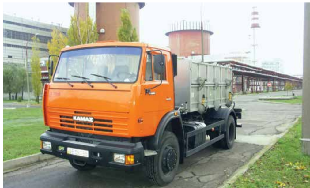
Спецавтомобіль ОТ-10 для транспортування радіоактивних відходів територією ЮУАЕС.
